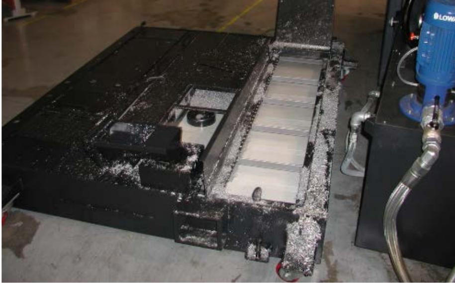
**Rugosità superficiale molto spinta di particolare idraulico settore industria aerospaziale ottenuto direttamente sul tornio grazie alla pulizia del refrigerante e all'integrazione di lavorazioni precedentemente eseguite fuori macchina**
