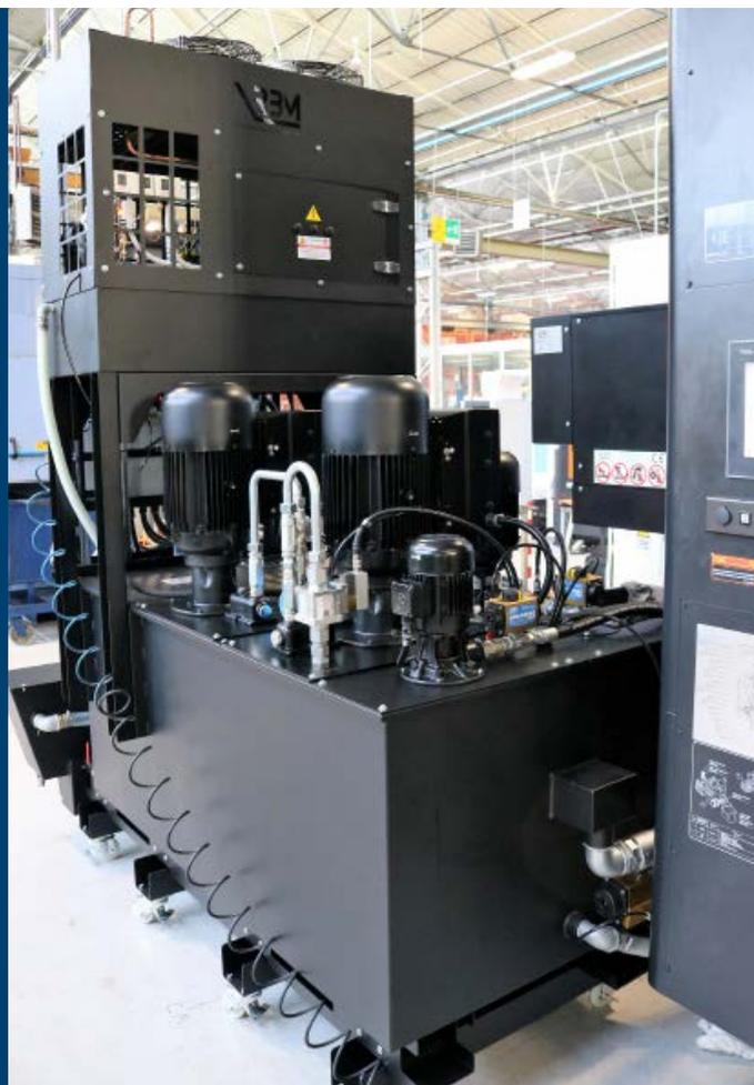
**Gestire il calore generato dalle pompe e dalle lavorazioni grazie al frigo permette di ovviare all'impegno economico e di spazio derivante dall'aumento del volume di fluido da taglio impiegato per tale scopo**
