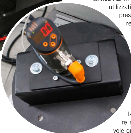
Trasduttore applicato sulla vasca di una macchina utensile Trasduttore di livello da montare sulle vasche delle macchine utensili
