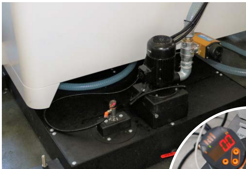
Trasduttore applicato sulla vasca di una macchina utensile Trasduttore di livello da montare sulle vasche delle macchine utensili
