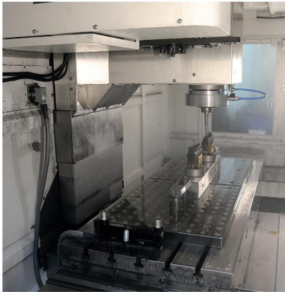
**Di lato, livello di pulizia interna della macchina utensile grazie all'abbattimento delle polveri durante la lavorazione.**
