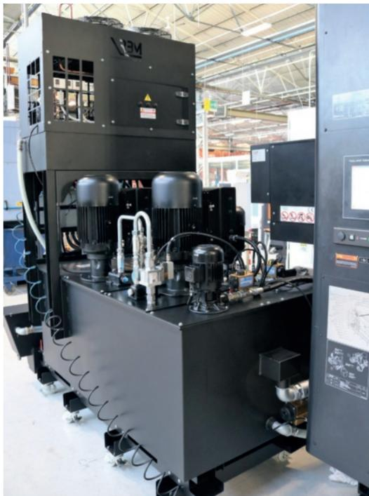
Gli impianti di filtrazione RBM garantiscono una filtrazione di particelle di dimensioni fino a 10µm, costante nel tempo.
