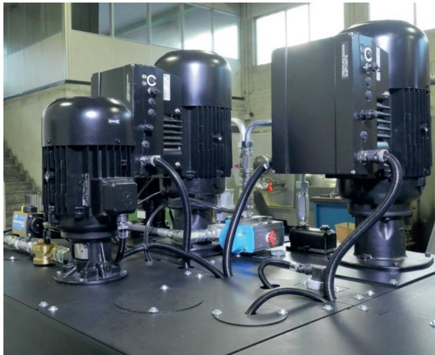
Il sistema Duplex varia automaticamente il rapporto pressione/portata, lasciando all'operatore solo la scelta della pressione prescritta per ogni utensile.
