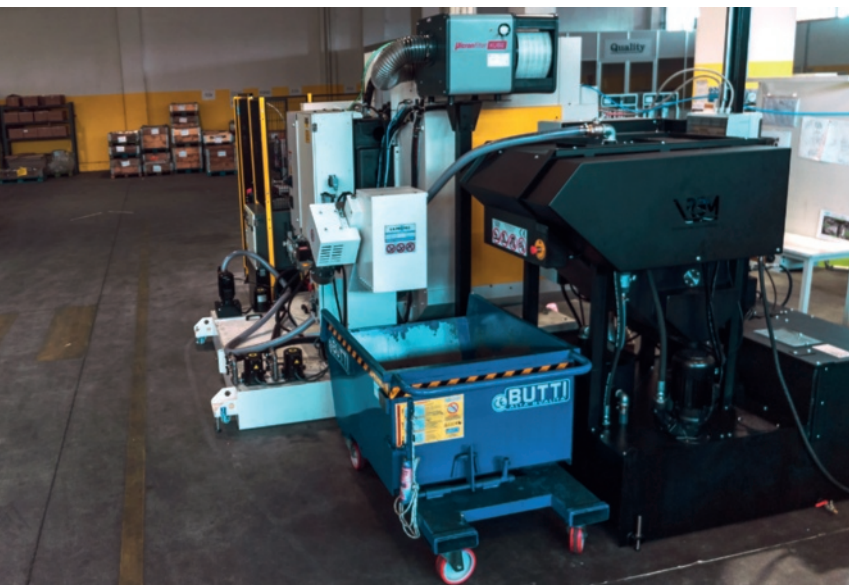
Vista d'insieme lato posteriore Robodrill e CO-RE per risolvere problematiche esistenti sulle vasche del lubrorefrigerante standard.
